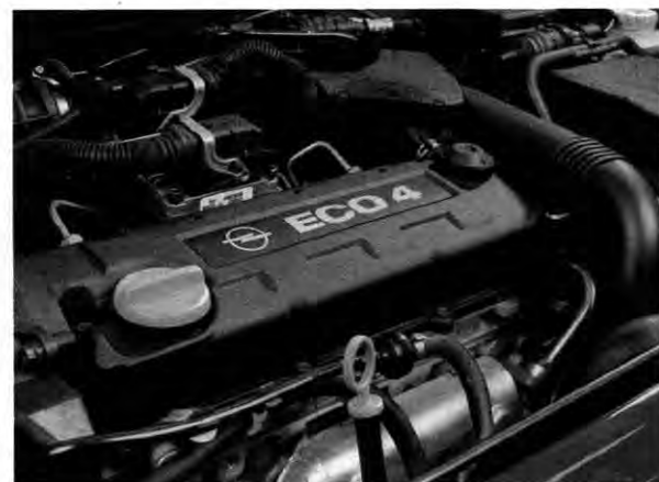
Herzstück: Mit dem 1.7-Liter-Direkteinspritzer-Turbodiesel ist der Eco 4 flott unterwegs, knausert aber beim Sprit
