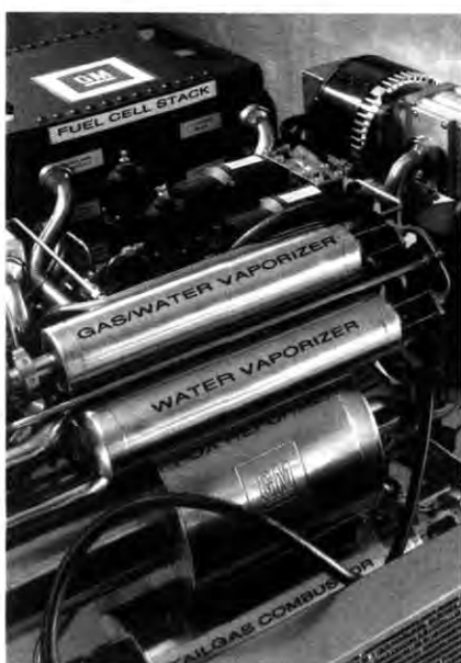
Technik für die Zukunft: Reformer (l.) und Brennstoffzellen- Block (o.) sollen künftige Opel- Modelle beson- ders umwelt- verträglich voran- bringen
