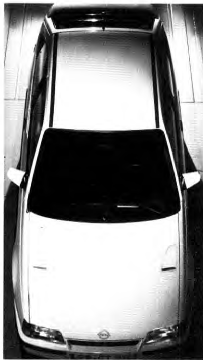
Die Karosserieform des neuen Kadett ähnelt jenen Tropfen-Konturen, die in der Aerodynamik als strömungstechnisch ideal gelten. Mit einem C_w -Wert von 0,30 und der vergleichsweise geringen Stirnfläche von 1,90 \text{ m}^2 ist der GSi (Foto) unter den Automobilen der Welt die Serienlimousine mit der derzeit geringsten Luftwiderstandsfläche überhaupt ( C_w \times A = 0,57 \text{ m}^2 ).
