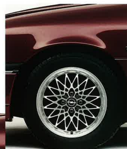
Leichtmetallrad, 17 50 321, 6 J x 15, mit ABE, radfrontkopiert. Farbe: Schwarz, Zierkappe für Radnabe und Abdeckkappen für Radschrauben.
