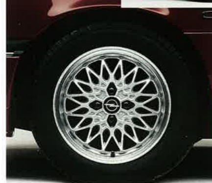
Leichtmetallrad, 17 50 321, 6 J x 15, mit ABE, radfrontkopiert. Farbe: Schwarz, Zierkappe für Radnabe und Abdeckkappen für Radschrauben.
