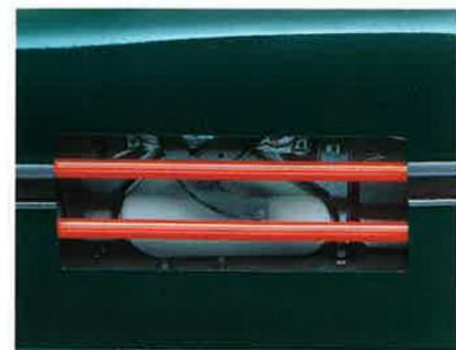
Integrierte Doppel-Stahlrohrverstärkungen in den Seitentüren.
