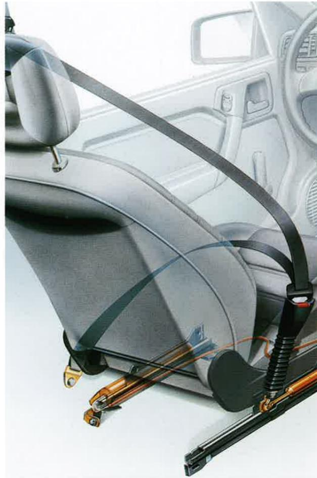
Höheneinstellbare Sicherheitsgurte vorn und hinten. Blitzschnelles Straffen der Gurte schon bei einer Unfallschwere, die einem Mauer-aufprall mit 20 km/h entspricht.
