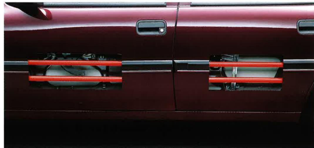
Die integrierte Doppel-Stahlrohrver-stärkung in den Sei- tentüren für verbes- serten Insassenschutz bei den meisten seit- lichen Kollisionen.
