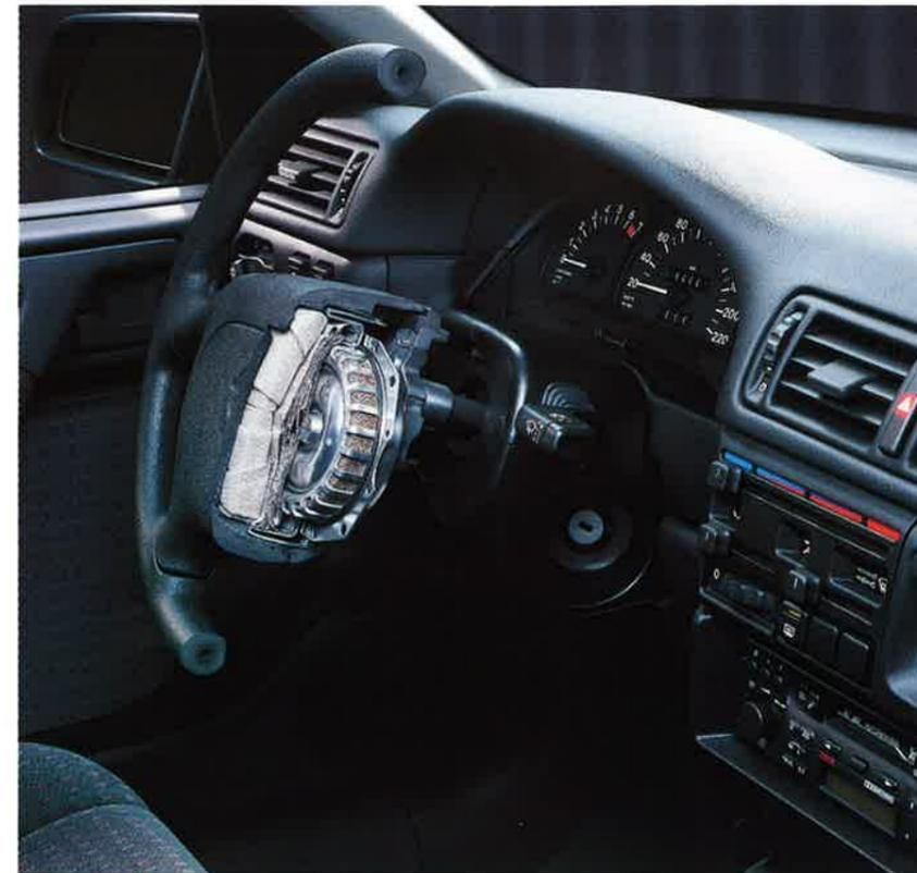
Der zusammengefaltete Airbag im Pralltopf des Lenkrades.
