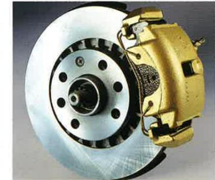
Diagonales Zweikreisbremssystem mit Bremskraftverstärker und Bremskraftregler. Bei 1.6i-, 1.8i- und 1.7-TD-Motoren Scheibenbremsen vorn und Trommelbremsen hinten; beim 2.0i- und 2.5i-Motor Scheibenbremsen vorn und hinten (vorn innenbelüftet). Asbestfreie Bremsbeläge, ABS serienmäßig.
