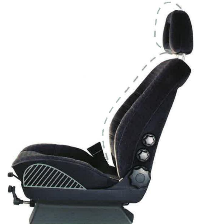
Fahrer- und Beifahrersitz. Sitzflächen aus Voll- schaum mit zwei Härtezo- nen. Höhere Härte an den Seiten der Rücken- lehnen für bessere Stütz- wirkung, optimierter Komfort in der Sitz- fläche durch weiche- ren Schaum. Integrierte Gurtbefestigung und eingearbeitete Stützrampe verhindern das Wegtauchen unter dem Becken- gurt bei einer Kollision. Ab GLS serienmäßig mit Lendenwirbelstützen.
