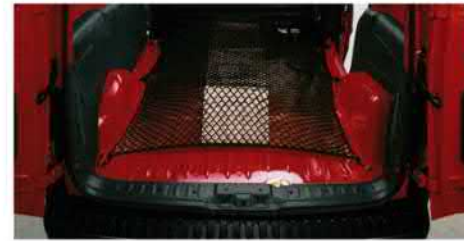
Das Laderaumnetz verhindert das Herumrutschen kleinerer Fracht während der Fahrt.
