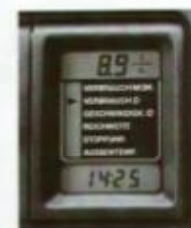
Ein Bordcomputer liefert ständig aktuelle Infos über den durchschnittlichen und den augenblicklichen Kraftstoffverbrauch, die Durchschnittsgeschwin-
