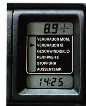
Ein Bordcomputer liefert ständig aktuelle Infos über den durchschnittlichen und den augenblicklichen Kraftstoffverbrauch, die Durchschnittsgeschwindigkeit, die Außentemperatur, die momentane Reichweite und natürlich die Uhrzeit. Darüber hinaus ist eine Stoppuhr integriert (Sonderausstattung).
