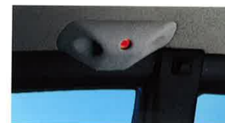
Diebstahlwarnanlage mit Ultraschallsensoren.
