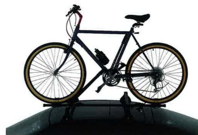
Fahrrad-Dachgepäckträger. Befestigt an versenkten, durch Schiebeleisten verdeckte Montagepunkten.
