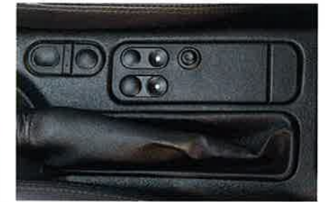
Elektrische Fensterheber. Die Fensterheber funktionieren mit elektronischer Sicherheitslogik.
