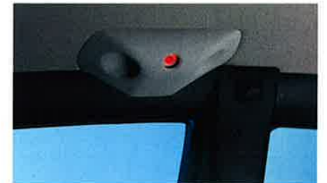
Diebstahlwarnanlage mit Ultraschallsensoren.
