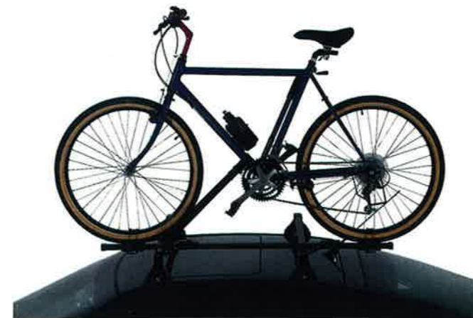
Fahrrad-Dachgepäckträger. Befestigt an versenkten, durch Schiebeleisten verdeckten Montagepunkten.
