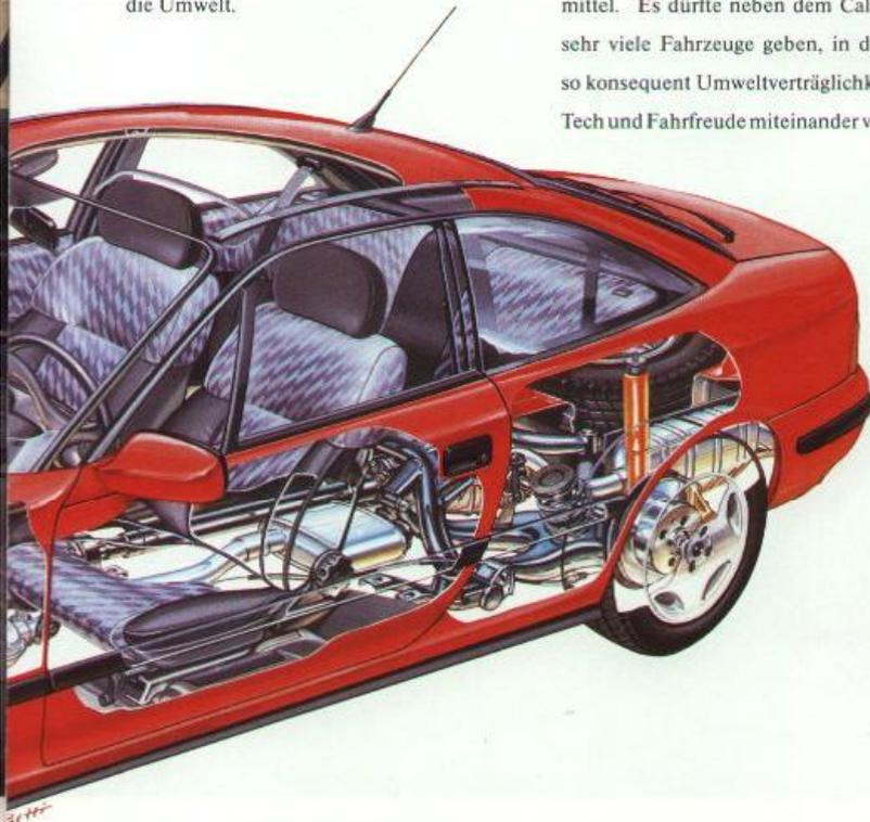
ABS (Antiblockiersystem) verhindert sowohl bei einer Vollbremsung als auch bei Nässe, Eis und Schnee das Blockieren der Räder und ermöglicht dadurch die Lenkfähigkeit, bis das Fahrzeug praktisch zum Stillstand gekommen ist.
