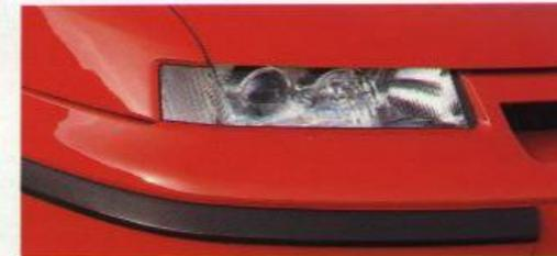
ein rein formales Element. Dahinter steckt hochmoderne Technik: die neuen Ellipsoid-Scheinwerfer. Hinter einer nur 7 Zentimeter hohen Einheit sind Blinkleuchten, Abblend- und Fernlicht und auf Wunsch auch Nebelscheinwerfer (Serienausstattung beim Calibra 16V) untergebracht. Fahrlicht und Nebelscheinwerfer arbeiten mit einer Kombination aus Reflektor und Linse, eben dem Ellipsoid-System.
