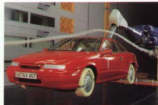
Stoßfänger sind weitere Beispiele für die aufwendige Arbeit der Opel-Techniker und -Ingenieure. Aufgrund dieser unerreichten aerodynamischen Qualitäten des Calibra wurde nicht nur der Kraftstoffverbrauch spürbar gesenkt, man erreichte auch einen sehr niedrigen Auftriebswert an der Hinterachse - übrigens ohne Einsatz eines zusätzlichen Heckspoilers. Die Folge: Bis zur Höchstgeschwindigkeit zeichnet sich der Calibra durch eine sehr gute Geradeauslauf-Stabilität aus.
