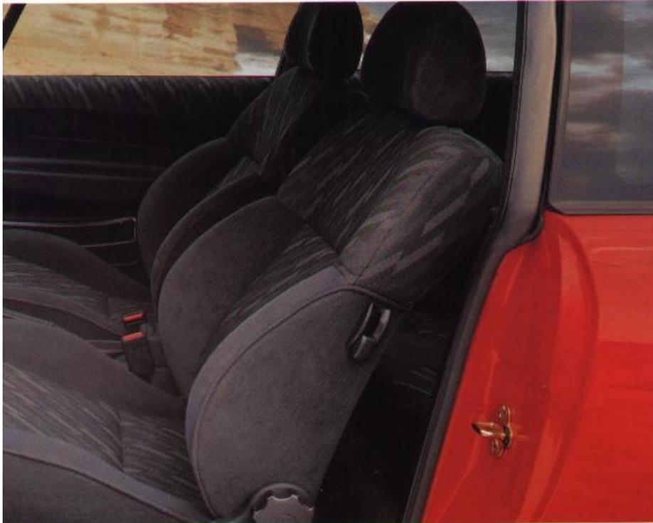
Der in der Höhe einstellbare Fahrersitz bringt jeden Fahrer in seine optimale Sitzposition und die Sportsitze vorne bieten dank verstärkter Seitenführung auch bei sehr sportlicher Fahrweise festen Halt. Im Fond: Gut ausgeformte Sitze, breite Armlehnen
