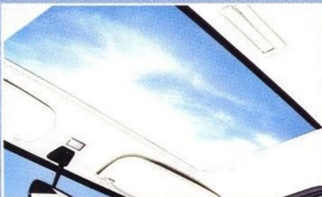
Für Frischluft-Fans: Stahlschiebedach - in jeder Stellung arretierbar.
