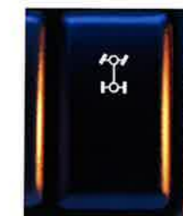
Eine von vielen Innovationen im Frontera. Das No-Stop-Allradsystem NSA. Elektronisches Umschalten auf 4x4- oder Normal-Antrieb bei Geschwindigkeiten bis 100 km/h.
