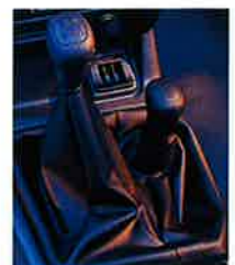
Wenn es mal ganz dick kommt: Einfach die Geländeuntersetzung einschalten – und schon geht's weiter.
