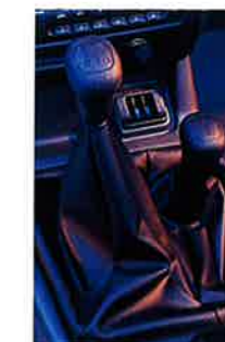
Zuschaltbare Geländeuntersetzung für maximale Durchzugskraft bei extrem niedriger Geschwindigkeit.
