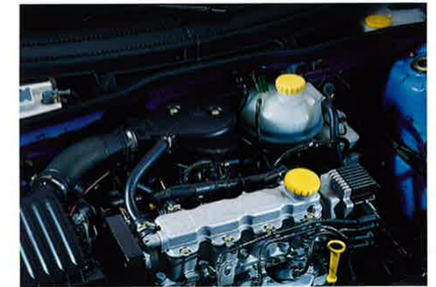
Der neue 1.2i-Basis- motor mit 33 kW (45 PS): optimale Leistung bei niedri- gem Drehmoment.
